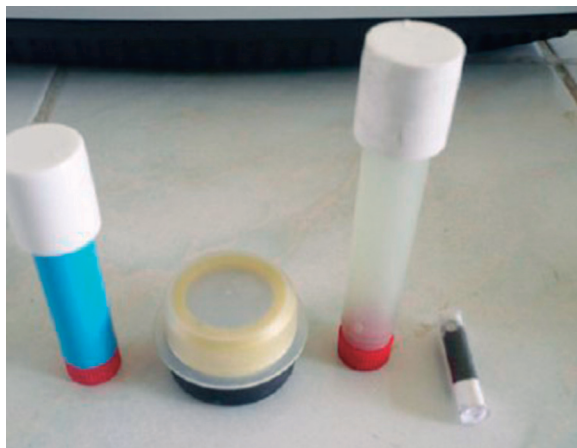
Figura 3. Dispositivos empleados en el muestreo pasivo de contaminantes gaseosos Fuente: (Municipalidad de Cuenca, 2015)
