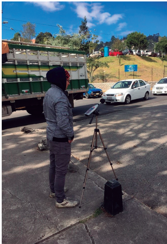
Figura 4. Operador de sonómetro en proceso de medición
