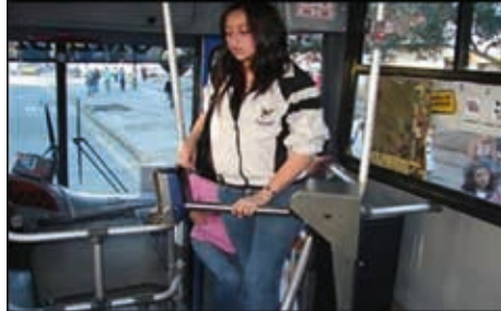
Fotografía 6: Torniquete instalado en las unidades de transporte público urbano Fuente: eltiempo.com.ec
