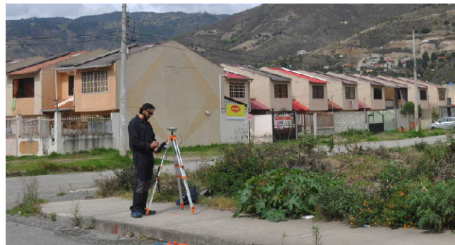
Figura 1. Medición de Puntos de control (GCP)
