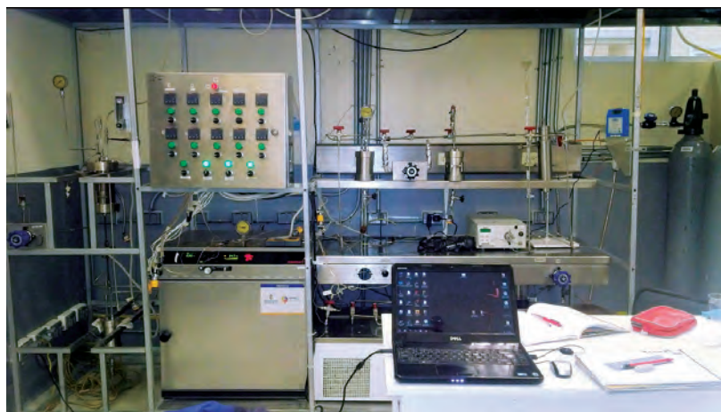
Figura 1: Equipo de extracción mediante fluidos supercríticos
