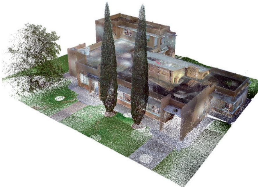
**Figura 6:** Modelo tridimensional obtenido mediante láser escáner
