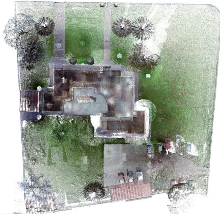
Figura 8: Ortofoto mediante láser escáner
