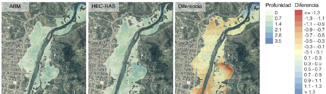
Figura 5. Izquierda: Mapa de inundaciones producido con el ABM calibrado. Centro: Mapa de inundaciones producido con el modelo hidráulico HEC-RAS. Derecha: Diferencia de las profundidades de inundación entre los dos modelos.
