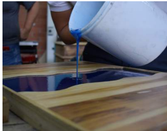
Figura 20. Aplicación de pintura epóxica pigmentada
