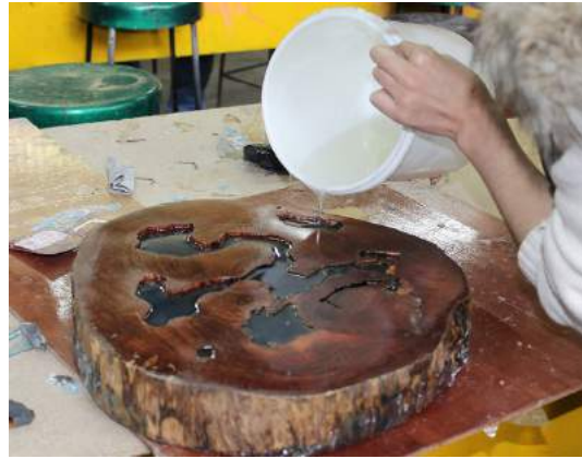
Figura 18. Aplicación de pintura epóxica en tronco de madera
