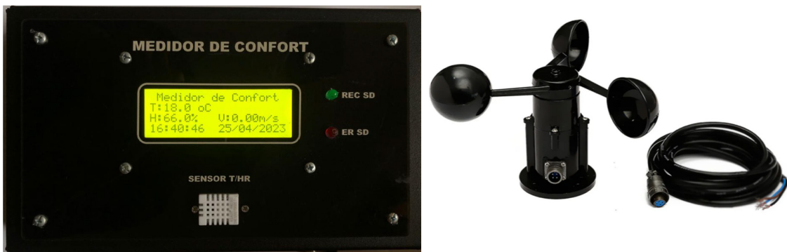
Figura 2. Imagen tomada y modificada de la página de Michel Solís Bordifilista Nota. a) Sensor de temperatura y humedad. b) Anemómetro.
